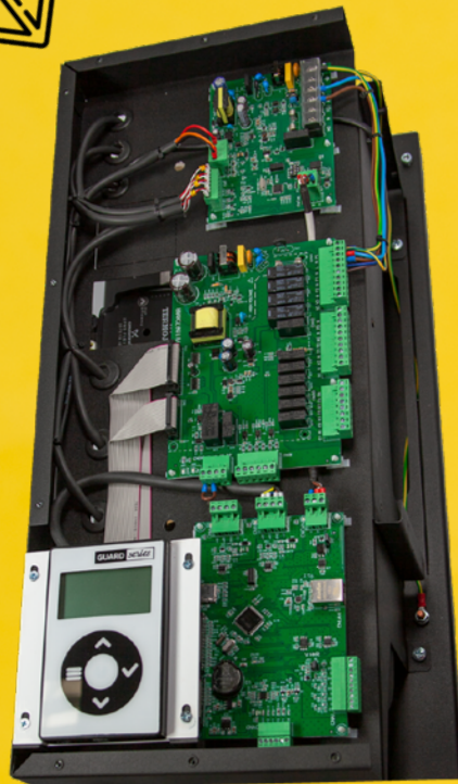
Модернізована плата керування з вбудованим Ethernet та підтримкою протоколу Modbus IP
